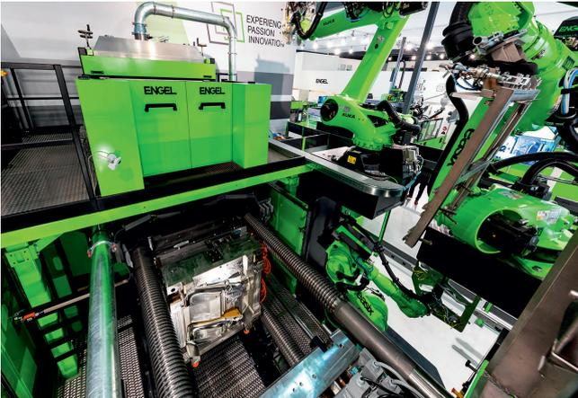
**Bild 2.** Zwei Roboter sind nebeneinander oberhalb der Schließeinheit platziert und handhaben die Organobleche, der dritte wartet neben der Schließeinheit auf das Entformen des fertigen Bauteils (© Engel)
