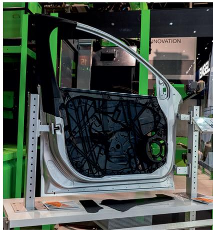
**Bild 3.** Das Seitentürmodul in der realen Einbausituation (© Engel)
